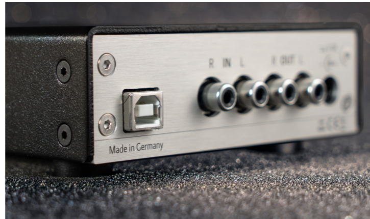
Der USB-Port akzeptiert Stecker des Typs USB-B. Diese Buchse ist der sichtbare Teil des USB-Moduls, das sich auf einer eigenen Platine im Gehäuseinneren befindet.
