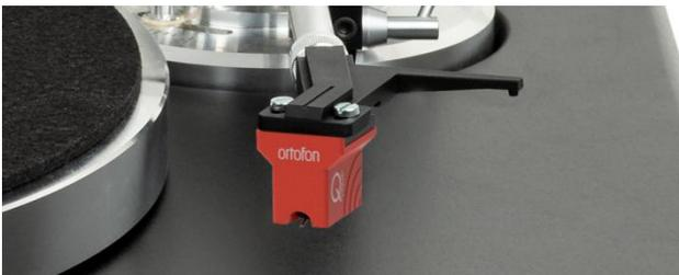
Wie beim Auto der Reifen ist der Tonabnehmer, oder besser seine Abtastnadel, die eigentliche relevante Kontaktfläche. Sie liest die mikroskopisch kleinen Modulationen aus der Schallplattenrinne und erzeugt daraus die
