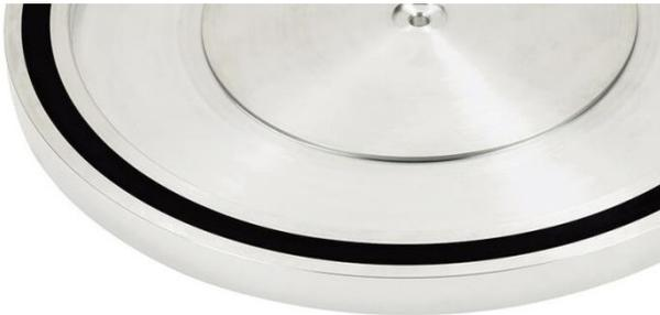
Der Hauptteller selbst besteht aus Aluminium, ist aus dem Vollen gedreht und wird am Rand durch eine schwingungsdämpfende Masse beruhigt. Dies verhindert unerwünschte Resonanzbildung in der Nähe des Tonabnehmers sehr effektiv. Aluminium ist antimagnetisch und verhindert somit eine
