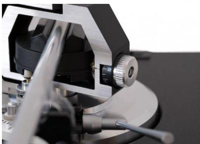
Der Tonarm ist das Führungsinstrument des Tonabnehmers. Um diesen perfekt arbeiten zu lassen treibt REKKORD einen hohen Aufwand. Die kardanischen Lager höchster Güte werden in zwei massiven Aluminiumblöcken geführt. So werden sich gegenseitig aufschaukelnde Resonanzen gezielt verhindert. Die Auflagekraft wird masselos per Feder ausgeübt.
