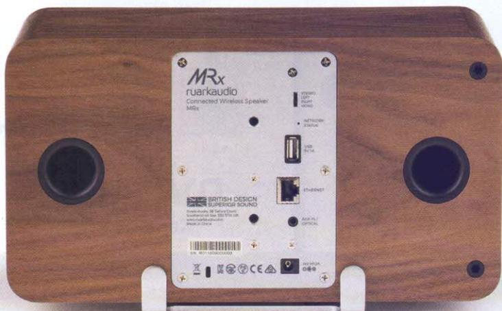
Neben Wi-Fi- und Bluetooth-Empfängern bietet das Ruark MRx einen Ethernet-Anschluss, eine Analog-Digital-Kombi-Buchse (Miniklinke) sowie einen USB-Eingang
