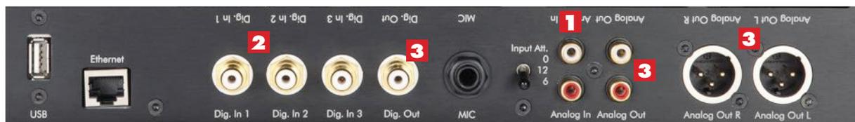
**Hier rein, da raus:** Der Audiovolver lässt sich auf unterschiedliche Arten ins HiFi-Setup integrieren. Am direktesten ist es, eine Quelle (z.B. CD-Spieler) in seinen analogen **1** oder digitalen **2** Eingang zu speisen und über einen der Ausgänge **3** in den Verstärker zu gehen. So kommt allerdings nur ein Gerät in den Genuss der Korrektur. Galanter ist es daher, den Raumprozessor in die
